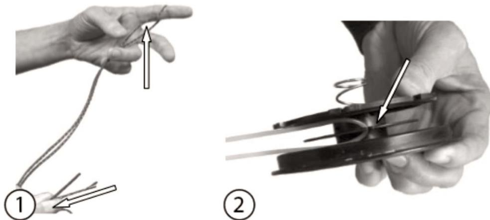
Отмерьте 5-6 м лески и сложите ее пополам (1). Зацепите петлю лески за технологическое отверстие на среднем ребре шпульки. (2).
