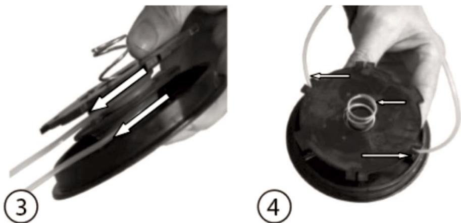
Намотайте леску в два ручья в направлении, указанном на шпульке стрелкой (3). Закрепите концы лески длиной 10-15 см в пазы на шпульке. Установите пружину. (4).
