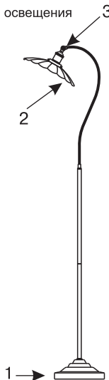
Рис.1, конструкция: 1. Основание 2. Плафон 3. Фиксирующий винт
