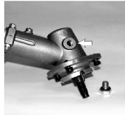
Раз в три месяца проверяйте наличие смазки в редукторе. При необходимости надо сменить смазку или обратиться в авторизованный сервисный центр. Для смазки редуктора можно использовать оригинальную смазку. Перед обслуживанием редуктора промойте его универсальным очистителем.
