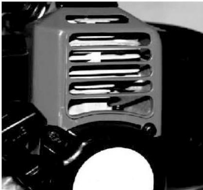
При загрязнении охлаждающих отверстий продуктами покоса и масляным шламом используйте для очистки кисточку и/или балон со сжатым воздухом. Грязные ребра цилиндра двигателя могут стать причиной его перегрева и поломки. Регулярно очищайте от загрязнений ребра цилиндров кисточкой и/или сжатым воздухом.
